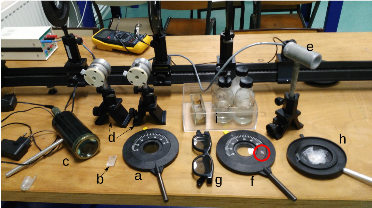
FIGURE 4.7: a) Polariseur (vérifier avec une source polarisée (e.g. écran LCD)). b) Cristal de Calcite. c) Lampe LED blanche (sans IR donc). d) lame demi onde ( \lambda/2 ) et quart d'onde ( \lambda/4 ) à 532nm. e) Photodiode + alim + multimetre : intensité proportionnelle à la tension. f) Quart d'onde ( \lambda/4 ) en polymère large bande. g) Lunette 3D h) Monture avec scotch i) Solution de D-glucose + cuve. NB : photo non contractuelle.
